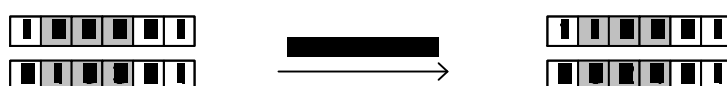
Figura 2.2. Operación de cruzamiento de dos puntos. El primer punto de cruce es 2 mientras que la longitud del segmento a intercambiar es 3
